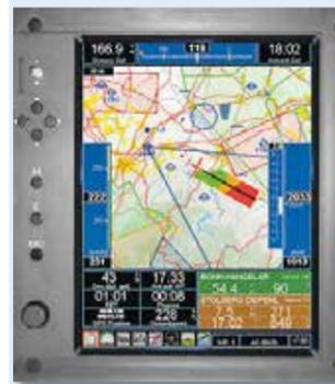
rik für Fahrt, Höhe, Vario, GPS, künstlicher Horizont mit Kompass und ADSB-Empfänger für die grafische Kollisionswarnung. Optional ist die Motorüberwachung mit gleichzeitiger Darstellung auf dem Display erhältlich. Peschges Variometer GmbH, Zieglerstr. 11, D-52078 Aachen, Fon +49 (0)241 180 59 400, www.peschges-variometer.de, Mail: vertrieb@peschges-variometer.de
